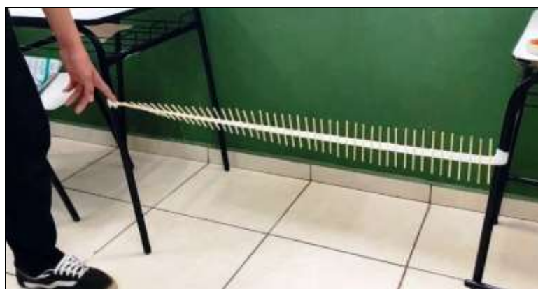
Figura 5 – Aluno manuseando a “máquina de ondas” construída com palitos de 10 cm Fonte: arquivo dos autores
