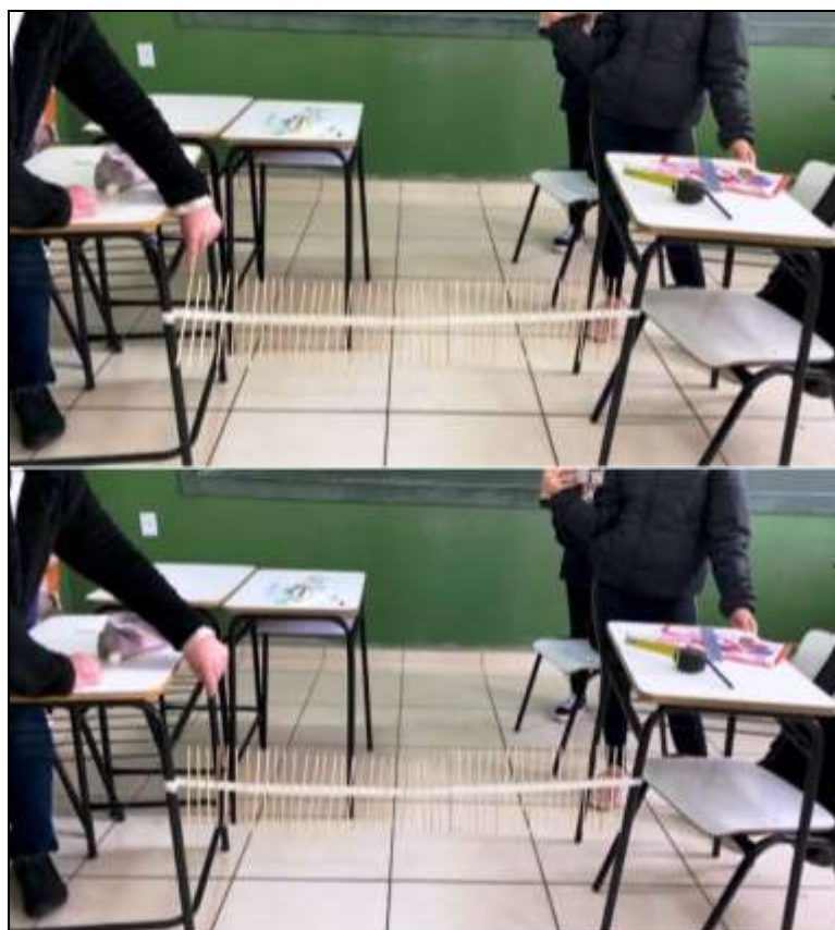
Figura 3 – Alunos manuseando a “máquina de ondas” construída com palitos de 20 cm Fonte: arquivo dos autores
