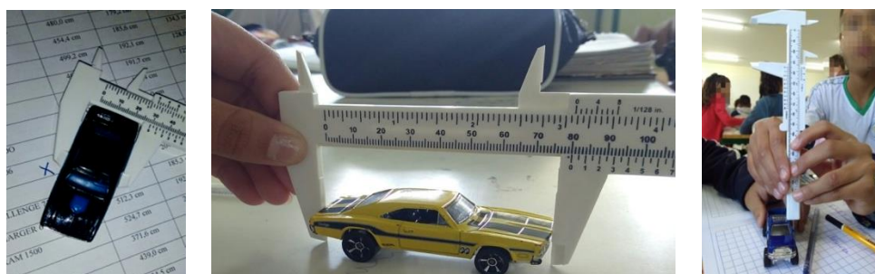
Figura 4 – Uso do paquímetro pelos alunos para determinar as dimensões das miniaturas Fonte: os autores
