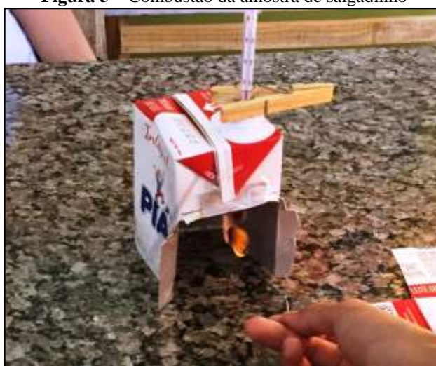
Figura 5 – Combustão da amostra de salgadinho
